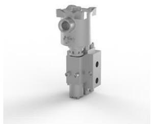
Электромагнитный клапан, нержавеющая сталь 316, порты 1/4 NPT, 3-позиционный 2-позиционный, непрямого действия, нормально закрытый, Ex d, 24 В постоянного тока, 3,0 Вт, автоматический сброс, ввод кабеля 1/2 NPT.
