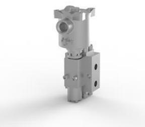
Электромагнитный клапан, нержавеющая сталь 316, порты 3/8 NPT, 3-позиционный, 2 положения, непрямого действия, нормально закрытый, Ex d, 24 В постоянного тока, 3,0 Вт, автоматический сброс, M20 x 1,5 кабельного ввода.
