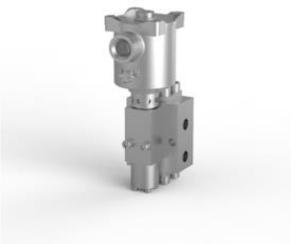
Электромагнитный клапан, нержавеющая сталь 316, порты 1/4 NPT, 3-позиционное 2-позиционное, непрямого действия, нормально закрытый, взрывозащищенный, 24 В постоянного тока, 3,6 Вт, автоматический сброс, M20 x 1,5 кабельного ввода.
