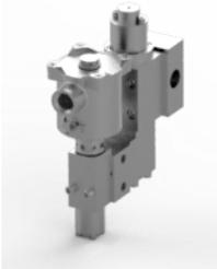
Электромагнитный клапан, нержавеющая сталь 316, порты 1/2 NPT, 3-позиционный, 2 положения, непрямого действия, нормально закрытый, Ex d, 24 В постоянного тока, 3,0 Вт, автоматический сброс, M20 x 1,5 кабельного ввода.
