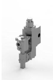
Электромагнитный клапан, нержавеющая сталь 316, порты 1/2 NPT, 3-позиционный, 2 положения, непрямого действия, нормально закрытый, Ex d, 24 В постоянного тока, 3,0 Вт, автоматический сброс, M20 x 1,5 кабельного ввода.
