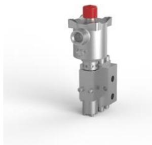
Электромагнитный клапан, нержавеющая сталь 316, порты 1/4 NPT, 3-позиционный, 2 положения, непрямого действия, нормально закрытый, взрывозащищенный, 24 В постоянного тока, 3,6 Вт, ручной сброс, M20 x 1,5 кабельного ввода.
