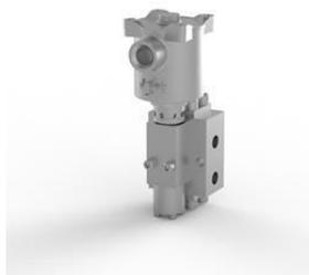
Электромагнитный клапан, нержавеющая сталь 316, порты 1/4 NPT, 3-позиционный, 2 положения, непрямого действия, нормально закрытый, Ex d, 24 В постоянного тока, 3,0 Вт, автоматический сброс, M20 x 1,5 кабельного ввода.
