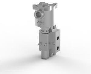
Электромагнитный клапан, нержавеющая сталь 316, порты 1/4 NPT, 3-позиционный, 2 положения, непрямого действия, нормально закрытый, Ex d, 24 В постоянного тока, 3,0 Вт, автоматический сброс, M20 x 1,5 кабельного ввода.
