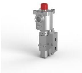
Электромагнитный клапан, нержавеющая сталь 316, порты 1/4 NPT, 3-позиционный, 2 положения, непрямого действия, нормально закрытый, Exia, 155 Ом, ручной сброс, M20 x 1,5 кабельного ввода.
