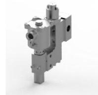
Электромагнитный клапан, нержавеющая сталь 316, порты 1/2 NPT, 3-позиционный, 2 положения, непрямого действия, нормально закрытый, Ex d, 24 В постоянного тока, 3,0 Вт, автоматический сброс, M20 x 1,5 кабельного ввода.
