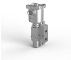
Электромагнитный клапан, нержавеющая сталь 316, порты 1/4 NPT, 3-позиционное 2-позиционное, непрямого действия, нормально закрытый, взрывозащищенный, 24 В постоянного тока, 3,6 Вт, автоматический сброс, M20 x 1,5 кабельного ввода.
