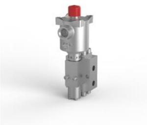
Электромагнитный клапан, нержавеющая сталь 316, порты 1/4 NPT, 3-позиционный, 2 положения, непрямого действия, нормально закрытый, взрывозащищенный, 24 В постоянного тока, 3,6 Вт, ручной сброс, M20 x 1,5 кабельного ввода.
