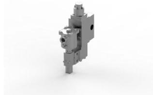
Электромагнитный клапан, нержавеющая сталь 316, порты 1/2 NPT, 3-позиционный, 2 положения, непрямого действия, нормально закрытый, Ex d, 24 В постоянного тока, 3,0 Вт, автоматический сброс, M20 x 1,5 кабельного ввода.
