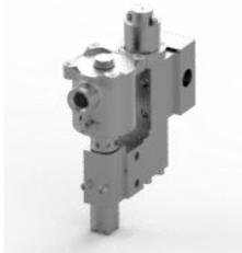
Электромагнитный клапан, нержавеющая сталь 316, порты 1/2 NPT, 3-позиционный, 2 положения, непрямого действия, нормально закрытый, Ex d, 24 В постоянного тока, 3,0 Вт, автоматический сброс, M20 x 1,5 кабельного ввода.
