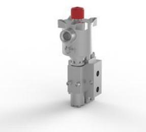
Электромагнитный клапан, нержавеющая сталь 316, 3/8 порты среднего давления, 3-позиционный 2-позиционный, непрямого действия, нормально закрытый, Ex d, 24 В пост. Тока, ручной сброс, M20 x 1,5 кабельного ввода.
