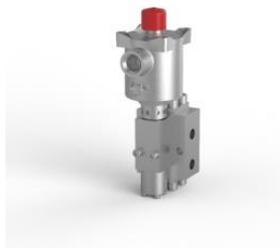
Электромагнитный клапан, нержавеющая сталь 316, порты 1/4 NPT, 3-позиционный, 2 положения, непрямого действия, нормально закрытый, Ex d, 24 В постоянного тока, 3,0 Вт, ручной сброс, M20 x 1,5 кабельного ввода.
