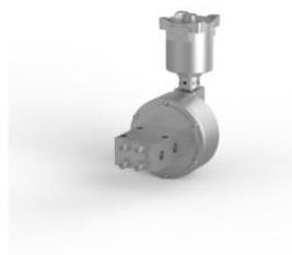
Электромагнитный клапан, нержавеющая сталь 316, порты 1/4 NPT, 3-позиционный, 2 положения, непрямого действия, нормально закрытый, Exia, 370 Ом, автоматический сброс, M20 x 1,5 кабельного ввода.
