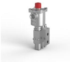
Электромагнитный клапан, нержавеющая сталь 316, порты 1/4 NPT, 3-позиционный, 2 положения, непрямого действия, нормально закрытый, взрывозащищенный, 24 В постоянного тока, 3,6 Вт, ручной сброс, M20 x 1,5 кабельного ввода.
