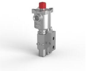
Электромагнитный клапан, нержавеющая сталь 316, порты 1/4 NPT, 3-позиционный, 2 положения, непрямого действия, нормально закрытый, Ex d, 24 В постоянного тока, 3,0 Вт, ручной сброс, M20 x 1,5 кабельного ввода.
