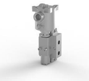
Электромагнитный клапан, нержавеющая сталь 316, порты 3/8 NPT, 3-позиционный, 2 положения, непрямого действия, нормально закрытый, Ex d, 24 В постоянного тока, 3,0 Вт, автоматический сброс, M20 x 1,5 кабельного ввода.
