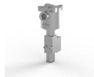
Электромагнитный клапан, нержавеющая сталь 316, 3-позиционное 2-позиционное, прямого действия, нормально закрытый, Viton, Ex d, 24 В пост. Тока, 3,0 Вт, автоматический сброс, M20 x 1,5 кабельного ввода.
