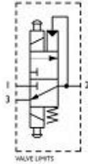
Гидравлические электромагнитные клапаны, 3-ходовые, 2-позиционные, прямого действия, нормально закрытые, импульсные, бистабильные, с гидравлической блокировкой, не закрываются при потере давления, возврат пружины с ручным управлением. 155 Ом, CV 0,01,690 бар. ATEX ex logo II I GD, Ex ia IIC T6
