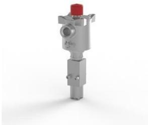
Электромагнитный клапан, нержавеющая сталь 316, 3-позиционное 2-позиционное, прямого действия, нормально закрытый, нитриловый, взрывозащищенный, 24 В постоянного тока, 3,6 Вт, ручной сброс, M20 x 1,5 кабельного ввода.
