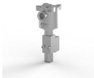
Электромагнитный клапан, нержавеющая сталь 316, 3-позиционное 2-позиционное, прямого действия, нормально закрытый, нитриловый, Ex d, 24 В постоянного тока, 3,0 Вт, с автосбросом, M20 x 1,5 кабельного ввода.
