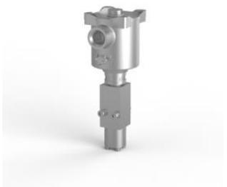
Электромагнитный клапан, нержавеющая сталь 316, 3-позиционное 2-позиционное, прямого действия, нормально закрытый, нитриловый, Exia, 155 Ом, автосброс, M20 x 1,5 кабельного ввода.
