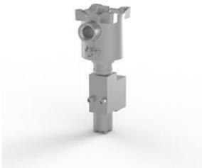
Электромагнитный клапан, нержавеющая сталь 316, 2-позиционный 2-позиционный, прямого действия, нормально открытый, нитриловый, Ex d, 24 В постоянного тока, 3,0 Вт, автоматический сброс, ввод кабеля 1/2 NPT.
