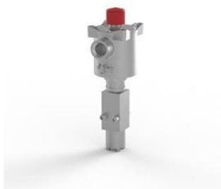
Электромагнитный клапан, нержавеющая сталь 316, 3-позиционный 2-позиционный, прямого действия, нормально закрытый, нитриловый, Ex d, 24 В постоянного тока, 3,0 Вт, ручной сброс, M20 x 1,5 кабельного ввода.
