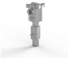
Электромагнитный клапан, нержавеющая сталь 316, 2-позиционная, 2-позиционная, прямого действия, нормально закрытый, нитриловый, Ex d, 24 В постоянного тока, 3,0 Вт, с автосбросом, M20 x 1,5 кабельного ввода.
