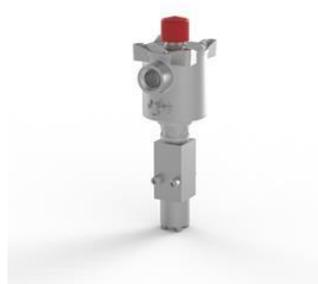
Электромагнитный клапан, нержавеющая сталь 316, 3-позиционный 2-позиционный, прямого действия, нормально закрытый, нитриловый, Ex d, 24 В постоянного тока, 3,0 Вт, ручной сброс, M20 x 1,5 кабельного ввода.
