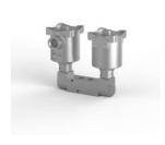
Электромагнитный клапан, нержавеющая сталь 316, порты 1/4 NPT, 5позиционный 2-позиционный, с пилотным управлением, непрямого действия, возврат пилота, взрывозащита, 24 В пост. Тока, автоматический сброс внутреннего пилотного сигнала, M20 x 1,5 кабельного ввода, CV 0,73.
