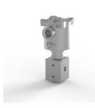
Электромагнитный клапан, нержавеющая сталь 316, порты 1/4 NPT, 3-позиционный 2-позиционный, прямого действия, обычно универсальный, Ex d, 24 В постоянного тока, 3,5 Вт, автоматический сброс, M20 x 1,5 кабельного ввода, CV 0,50.
