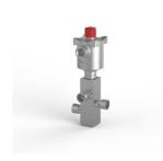
Электромагнитный клапан, нержавеющая сталь 316, порты 1/2 NPT, 3-позиционный 2-позиционный, с пилотным управлением, непрямого действия, с пружинным возвратом, Ex d, 24 В постоянного тока, внутренний пилот с ручным сбросом, M20 x 1,5 кабельный ввод, Cv 3.90.
