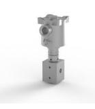
Электромагнитный клапан, нержавеющая сталь 316, порты 1/4 NPT, 3-позиционный 2-позиционный, прямого действия, обычно универсальный, Ex d, 24 В постоянного тока, 5,7 Вт, автоматический сброс, ввод кабеля 1/2 NPT, CV 0,75.
