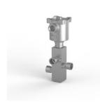
Электромагнитный клапан, нержавеющая сталь 316, порты 1/2 NPT, 3-позиционный 2-позиционный, с пилотным управлением, косвенного действия, с пружинным возвратом, Exia, внутренний пилот с автоматическим сбросом 260 Ом, кабельный ввод M20 x 1,5, CV 3,90.
