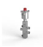
Электромагнитный клапан, нержавеющая сталь 316, порты 1/2 NPT, 5-позиционный 2-позиционный, с пилотным управлением, непрямого действия, с пружинным возвратом, Exia, 260 Ом, внутренний сброс с ручным сбросом, M20 х 1,5 кабельного ввода, CV 3,90.
