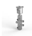
Электромагнитный клапан, нержавеющая сталь 316, порты 1/2 NPT, 5-позиционный 2-позиционный, с пилотным управлением, косвенного действия, с пружинным возвратом, Ex d, 24 В пост. Тока, внутренний сброс с автоматическим сбросом, M20 x 1,5 кабельный ввод, CV 3,90.
