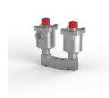
Электромагнитный клапан, алюминий, NAMUR, 5-позиционный 2-позиционный, с пилотным управлением, непрямым действием, с пружинным возвратом, Ex d, 24 В пост. Тока, с внутренним пилот-сигналом с автоматическим сбросом, M20 x 1,5 кабельный ввод, CV 0,73.
