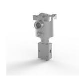
Электромагнитный клапан, нержавеющая сталь 316, порты 1/4 NPT, 3-позиционный 2-позиционный, прямого действия, обычно универсальный, Ex d, 24 В постоянного тока, 5,7 Вт, автоматический сброс, M20 х 1,5 кабельного ввода, Cv 0.75.
