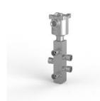
Электромагнитный клапан, нержавеющая сталь 316, порты 1/2 NPT, 5позиционный 2-позиционный, с пилотным управлением, косвенного действия, с пружинным возвратом, взрывозащищенный, 24 В пост.
