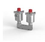
Электромагнитный клапан, нержавеющая сталь 316, порты 1/4 NPT, 5-позиционный 2-позиционный, с пилотным управлением, непрямого действия, возврат пилота, Ex d, 24 B пост. Тока, внутренний сброс с ручным сбросом, M20 x 1,5 кабельный ввод, CV 0,73.
