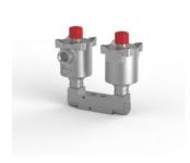
Электромагнитный клапан, нержавеющая сталь 316, NAMUR, 5-позиционная 2-позиционная, с пилотным управлением, косвенного действия, с пружинным возвратом, взрывозащита, 24 В пост. Тока, с внутренним пилот-сигналом с автоматическим сбросом, M20 x 1,5 кабельного ввода, CV 0,73.
