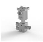
Электромагнитный клапан, нержавеющая сталь 316, порты 1/2 NPT, 3позиционный 2-позиционный, прямого действия, обычно универсальный, Ex d, 24 В постоянного тока, 5,7 Вт, с автосбросом, кабельный ввод 1/2 NPT, CV 0,75.
