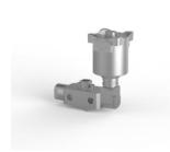
Электромагнитный клапан, нержавеющая сталь 316, NAMUR, 5-позиционная 2-позиционная, с пилотным управлением, косвенного действия, с пружинным возвратом, Ex d, 24 B пост. Тока, с внутренним пилот-сигналом с автоматическим сбросом, M20 x 1,5 кабельного ввода, CV 0,73.
