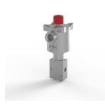
Электромагнитный клапан, нержавеющая сталь 316, порты 1/4 NPT, 3-позиционный 2-позиционный, прямого действия, обычно универсальный, Ex d, 24 В постоянного тока, 3,5 Вт, ручное управление, M20 x 1,5 кабельного ввода, CV 0,50.
