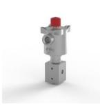
Электромагнитный клапан, нержавеющая сталь 316, порты 1/4 NPT, 3позиционный 2-позиционный, прямого действия, обычно универсальный, Ex d, 24 В постоянного тока, 3,0 Вт, ручной сброс, M20 x 1,5 кабельного ввода, CV 0,75.
