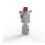
Электромагнитный клапан, нержавеющая сталь 316, порты 1/4 NPT, 3-позиционный 2-позиционный, прямого действия, обычно универсальный, Ex d, 24 В постоянного тока, 5,7 Вт, ручное управление, M20 x 1,5 кабельного ввода, CV 0,75.
