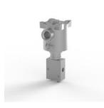
Электромагнитный клапан, нержавеющая сталь 316, порты 1/4 NPT, 3-позиционный 2-позиционный, прямого действия, обычно универсальный, Ex d, 24 В постоянного тока, 3,5 Вт, автоматический сброс, ввод кабеля 1/2 NPT, CV 0,50.
