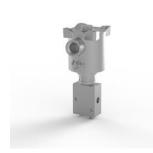
Электромагнитный клапан, нержавеющая сталь 316, порты 1/4 NPT, 3-позиционный 2-позиционный, прямого действия, обычно универсальный, Ex d, 24 В постоянного тока, 3,5 Вт, автоматический сброс, M20 x 1,5 кабельного ввода, CV 0.50.
