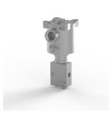
Электромагнитный клапан, нержавеющая сталь 316, порты 1/4 NPT, 3-позиционный 2-позиционный, прямого действия, обычно универсальный, Ex d, 24 В постоянного тока, 5,7 Вт, автоматический сброс, ввод кабеля 1/2 NPT, CV 0.75.
