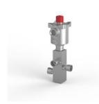
Электромагнитный клапан, нержавеющая сталь 316, порты 1/2 NPT, 3-позиционный 2-позиционный, с пилотным управлением, непрямого действия, с пружинным возвратом, взрывозащита, 24 В пост. Тока, с ручным сбросом, внутренний пилот, M20 х 1,5 кабельный ввод, CV 3,90.
