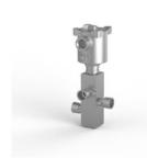
Электромагнитный клапан, нержавеющая сталь 316, порты 1/2 NPT, 3-позиционный 2-позиционный, с пилотным управлением, косвенного действия, с пружинным возвратом, Ex d, 24 В пост. Тока, внутренний сброс с автоматическим сбросом, M20 x 1,5 кабельный ввод, CV 3,90.
