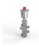
Электромагнитный клапан, нержавеющая сталь 316, порты 1/2 NPT, 5-позиционный 2-позиционный, с пилотным управлением, косвенного действия, с пружинным возвратом, Ex d, 24 В постоянного тока, внутренний пилот с ручным сбросом, M20 x 1,5 кабельный ввод, CV 3,90.
