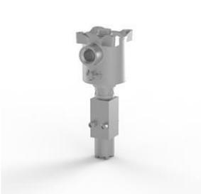
Электромагнитный клапан, нержавеющая сталь 316, 3-позиционное 2-позиционное, прямого действия, нормально закрытый, нитриловый, взрывозащищенный, 24 В пост. Тока, 3,6 Вт, с автосбросом, M20 x 1,5 кабельного ввода.
