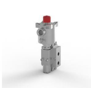
Электромагнитный клапан, нержавеющая сталь 316, порты 3/8 NPT, 3-позиционный, 2 положения, непрямого действия, нормально закрытый, Ex d, 24 В постоянного тока, 3,0 Вт, ручной сброс, M20 x 1,5 кабельного ввода.
