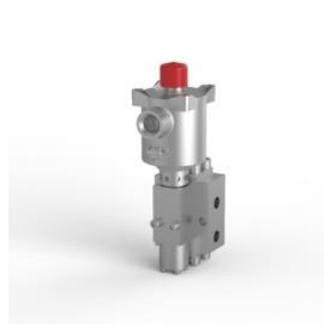
Электромагнитный клапан, нержавеющая сталь 316, порты 1/4 NPT, 3-позиционный, 2 положения, непрямого действия, нормально закрытый, Ex d, 24 В постоянного тока, 3,0 Вт, ручной сброс, M20 x 1,5 кабельного ввода.
