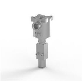
Электромагнитный клапан, нержавеющая сталь 316, 3-позиционное 2-позиционное, прямого действия, нормально закрытый, нитриловый, Ex d, 24 В постоянного тока, 3,0 Вт, с автосбросом, M20 x 1,5 кабельного ввода.
