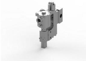
Электромагнитный клапан, нержавеющая сталь 316, порты 1/2 NPT, 3-позиционный, 2 положения, непрямого действия, нормально закрытый, Ex d, 24 В постоянного тока, 3,0 Вт, автоматический сброс, M20 x 1,5 кабельного ввода.
