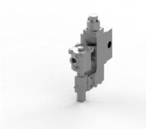
Электромагнитный клапан, нержавеющая сталь 316, порты 1/2 NPT, 3-позиционный, 2 положения, непрямого действия, нормально закрытый, Ex d, 24 В постоянного тока, 3,0 Вт, автоматический сброс, M20 x 1,5 кабельного ввода.
