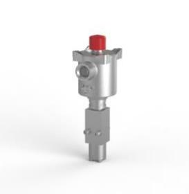
Электромагнитный клапан, нержавеющая сталь 316, 3-позиционный 2-позиционный, прямого действия, нормально закрытый, нитриловый, Ex d, 24 В пост. Тока, ручной сброс, M20 x 1,5 кабельного ввода.
