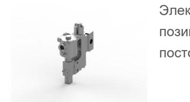
Электромагнитный клапан, нержавеющая сталь 316, порты 1/2 NPT, 3-позиционный, 2 положения, непрямого действия, нормально закрытый, Ex d, 24 В постоянного тока, 3,0 Вт, автоматический сброс, M20 x 1,5 кабельного ввода.
