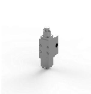
Интерфейсный клапан, нержавеющая сталь 316, 1/2 NPT, 250 бар, 3-х ходовой, 2 положения, пилот высокого давления, нитрил.
