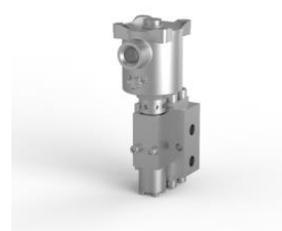
Электромагнитный клапан, нержавеющая сталь 316, порты 1/4 NPT, 3-позиционный, 2 положения, непрямого действия, нормально закрытый, Exia, 155 Ом, автоматический сброс, M20 x 1,5 кабельного ввода.
