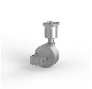
Электромагнитный клапан, нержавеющая сталь 316, порты 1/4 NPT, 3-позиционный, 2 положения, непрямого действия, нормально закрытый, Ex d, 24 В постоянного тока, 3,0 Вт, автоматический сброс, M20 x 1,5 кабельного ввода.
