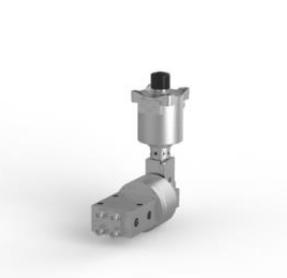
Электромагнитный клапан, нержавеющая сталь 316, порты 1/4 NPT, 3-позиционный, 2 положения, непрямого действия, нормально закрытый, Exia, 370 Ом, ручное управление, M20 x 1,5 кабельного ввода.
