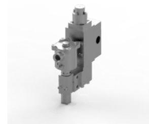
Электромагнитный клапан, нержавеющая сталь 316, порты 1/2 NPT, 3-позиционный, 2 положения, непрямого действия, нормально закрытый, Ex d, 24 В постоянного тока, 3,0 Вт, автоматический сброс, M20 x 1,5 кабельного ввода.
