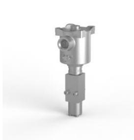
Электромагнитный клапан, нержавеющая сталь 316, 3-позиционное 2-позиционное, прямого действия, нормально закрытый, нитриловый, Exia, 155 Ом, автосброс, M20 x 1,5 кабельного ввода.
