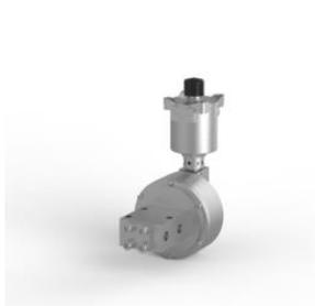
Электромагнитный клапан, нержавеющая сталь 316, порты 1/4 NPT, 3-позиционный, 2 положения, непрямого действия, нормально закрытый, взрывозащищенный, 24 В постоянного тока, 3,6 Вт, ручное управление, M20 x 1,5 кабельного ввода.
