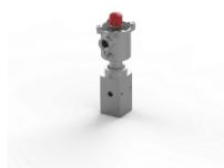
Электромагнитный клапан, нержавеющая сталь 316, 3-позиционный 2-позиционный, прямого действия, нормально закрытый, нитриловый, Ex d, 24 В постоянного тока, 3,0 Вт, ручной сброс, M20 x 1,5 кабельного ввода.
