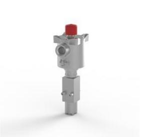
Электромагнитный клапан, нержавеющая сталь 316, 3-позиционный 2-позиционный, прямого действия, нормально закрытый, нитриловый, Ex d, 24 В постоянного тока, 3,0 Вт, ручной сброс, M20 x 1,5 кабельного ввода.
