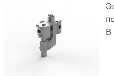
Электромагнитный клапан, нержавеющая сталь 316, порты 1/2 NPT, 3-позиционный, 2 положения, непрямого действия, нормально закрытый, Ex d, 24 В постоянного тока, 3,0 Вт, автоматический сброс, M20 x 1,5 кабельного ввода.
