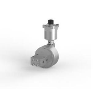
Электромагнитный клапан, нержавеющая сталь 316, порты 1/4 NPT, 3-позиционный, 2 положения, непрямого действия, нормально закрытый, Ex d, 24 В постоянного тока, 3,0 Вт, ручное управление, M20 x 1,5 кабельного ввода.
