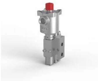
Электромагнитный клапан, нержавеющая сталь 316, порты 1/4 NPT, 3-позиционный, 2 положения, непрямого действия, нормально закрытый, Ex d, 24 В постоянного тока, 3,0 Вт, ручной сброс, M20 x 1,5 кабельного ввода.
