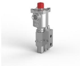
Электромагнитный клапан, нержавеющая сталь 316, порты 1/4 NPT, 3-позиционный, 2 положения, непрямого действия, нормально закрытый, взрывозащищенный, 24 В постоянного тока, 3,6 Вт, ручной сброс, M20 x 1,5 кабельного ввода.
