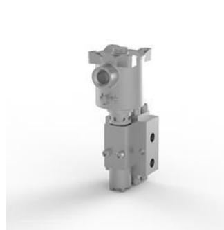
Электромагнитный клапан, нержавеющая сталь 316, порты 1/4 NPT, 3-позиционный 2-позиционный, непрямого действия, нормально закрытый, Ex d, 24 В постоянного тока, 3,0 Вт, автоматический сброс, ввод кабеля 1/2 NPT.
