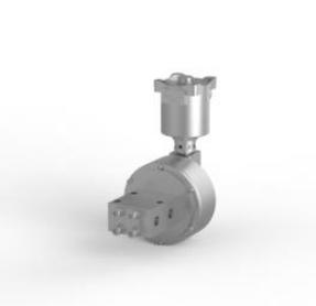
Электромагнитный клапан, нержавеющая сталь 316, порты 1/4 NPT, 3-позиционное 2-позиционное, непрямого действия, нормально закрытый, взрывозащищенный, 24 В постоянного тока, 3,6 Вт, автоматический сброс, M20 x 1,5 кабельного ввода.
