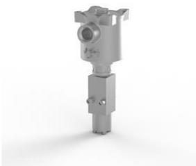
Электромагнитный клапан, нержавеющая сталь 316, 2-позиционная, 2-позиционная, прямого действия, нормально открытый, нитриловый, Ex d, 24 В постоянного тока, 3,0 Вт, с автосбросом, M20 x 1,5 кабельного ввода.
