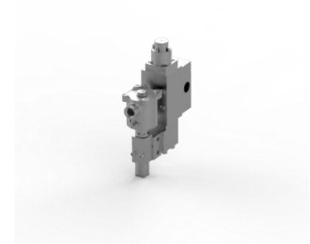
Электромагнитный клапан, нержавеющая сталь 316, порты 1/2 NPT, 3-позиционный, 2 положения, непрямого действия, нормально закрытый, Ex d, 24 В постоянного тока, 3,0 Вт, автоматический сброс, M20 x 1,5 кабельного ввода.
