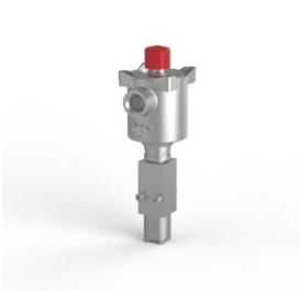
Электромагнитный клапан, нержавеющая сталь 316, 3-позиционное 2-позиционное, прямого действия, нормально закрытый, нитрил, Exia, 155 Ом, ручной сброс, M20 x 1,5 кабельного ввода.
