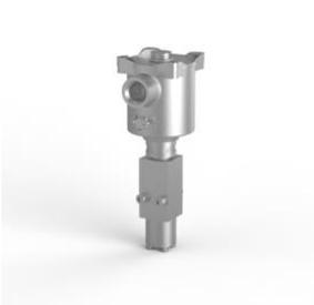
Электромагнитный клапан, нержавеющая сталь 316, 3-позиционное 2-позиционное, прямого действия, нормально закрытый, нитриловый, Exia, 155 Ом, автосброс, M20 x 1,5 кабельного ввода.
