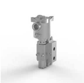
Электромагнитный клапан, нержавеющая сталь 316, порты 3/8 NPT, 3-позиционный, 2 положения, непрямого действия, нормально закрытый, Ex d, 24 В постоянного тока, 3,0 Вт, автоматический сброс, M20 x 1,5 кабельного ввода.
