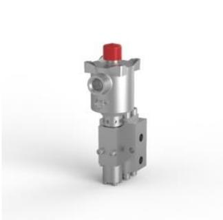
Электромагнитный клапан, нержавеющая сталь 316, порты 1/4 NPT, 3-позиционный, 2 положения, непрямого действия, нормально закрытый, взрывозащищенный, 24 В постоянного тока, 3,6 Вт, ручной сброс, M20 x 1,5 кабельного ввода.
