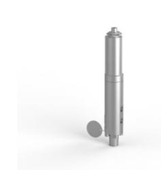
Пилотный клапан Flowline, из нержавеющей стали, с внутренней резьбой 1/4 NPT, с наружной резьбой 1/2 NPT, при падении на 2,5 - 10,5 бар или подъеме на 3 - 11 бар, 3-ходовой 2-позиционный, витон.
