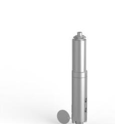
Пилотный клапан Flowline, из нержавеющей стали, с внутренней резьбой 1/4 NPT, с наружной резьбой 1/2 NPT, при падении 25–95 бар или подъеме 30–115 бар, 3-ходовой 2-позиционный, витон.
