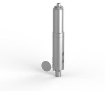
Пилотный клапан Flowline, из нержавеющей стали, с внутренней резьбой 1/4 NPT, с наружной резьбой 1/2 NPT, с падением 172 - 640 бар или с подъемом 205 - 680 бар, с 3 положениями, в 2 положениях, витон.
