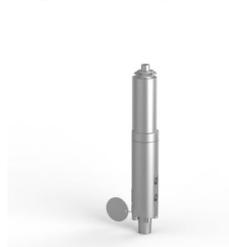
Пилотный клапан Flowline, из нержавеющей стали, с внутренней резьбой 1/4 NPT, с наружной резьбой 1/2 NPT, при падении 70 - 360 бар или подъеме 100 - 380 бар, 3-ходовой 2-позиционный, витон.
