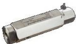
Предохранительный клапан, 90 - 620 бар, 3/8 МП на входе, exhaust NPT выхлоп
