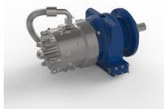
Водяной гликолевый насос, 3 поршня \* 0,500 \* 2/3 хода, 1,9 (США) г / м, 7,3 л / м, 4,16 куб. См / об. Теоретический расход, максимальное давление 700 бар До 870 бар Водяной гликолевый 2/3 ходовой насос ( 3 поршня)
