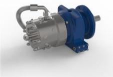
Водяной гликолевый насос, 3 поршня \* 0,437 \* 2/3 хода, 1,5 мкг / м, 5,6 л / м, теоретический расход 3,2 куб. См / об, максимальное давление 870 бар До 870 бар Водяной гликолевый 2/3 ходовой насос (3 поршня)
