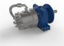
Водяной гликолевый насос, 3 поршня \* 0,437 хода, 2,2 кг / м, 8,4 л / м, теоретический расход 4,80 куб. См / об., Максимальное давление 700 бар До 870 бар Водяные насосы полного хода с гликолем (3 поршня)
