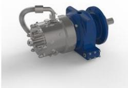
Водяной насос, 6 поршней \* 0,375 дюйма \* 2/3, теоретический расход 4,60 куб.см / об, максимальное давление 690 бар До 1000 бар Вода Гликоль или вода
