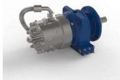
Водяной насос, 3 поршня \* 0,375 дюйма \* 2/3, 2,3 куб. См / об. Теоретический расход, максимальное давление 1000 бар До 1000 бар Вода Гликоль или Вода
