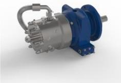
Водяной гликолевый насос, 3 поршня \* 0,437 \* 1/3 хода, 0,7 мкг / м, 2,8 л / м, теоретический расход 1,59 куб. См / об, максимальное давление 870 бар До 870 бар Водяной гликоль 1/3 тактных насоса (3 поршня)
