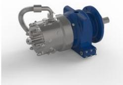
Водяной насос, 6 поршней \* 0,375 дюйма \* 2/3, теоретический расход 4,60 куб.см / об, максимальное давление 690 бар, водяное охлаждение - до 1000 бар - водный гликоль или вода
