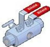
Двухблочный и выпускной клапан, DBB-коллектор, шар-игольчатая конфигурация, 3/4 NPT, 6000 фунтов на кв. Дюйм / 414 бар, 10-миллиметровое отверстие и 1/4 вентиляционное отверстие.
