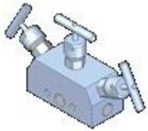
Двойной блок и отвод, одноканальный коллектор - игла - игла - конфигурация иглы, 1/4 NPT, 6000 фунтов на кв. Дюйм / 414 бар.
