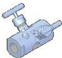
Двухклапанный инструментальный коллектор, блокировка и прокачка, конфигурация игла - игла, ¼ NPT, 6000 фунтов / кв. Дюйм / 414 бар, ¼ вентиляционное отверстие.
