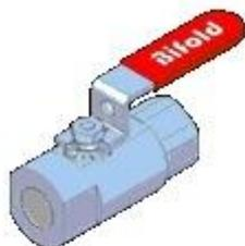
Шаровой клапан, одиночный изолятор, 1/2 "NPT, 10 000 фунтов на кв. Дюйм / 690 бар, диаметр отверстия 10 мм.
