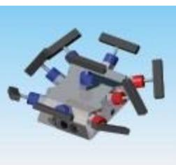
Среднее давление, трехсторонний коллектор с двойным блоком и отводом, конфигурация иглы-иглы, 3 / 8MP, 13 000 фунтов на кв. Дюйм / 896 бар и 1/4 MP Gauge Vent.
