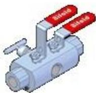
Двухблочный и выпускной клапан, DBB-коллектор, шар-игольчатый шар, 1/2 NPT, 6000 фунтов на квадратный дюйм / 414 бар, 10-миллиметровое отверстие и 1/4 вентиляционное отверстие.
