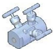
Игольчатый клапан для инструментов с двумя блоками и прокачкой, конфигурация иглы - иглы - иглы, ½ NPT, 10000 фунтов на кв. Дюйм / 690 бар, ent вентиляционное отверстие.
